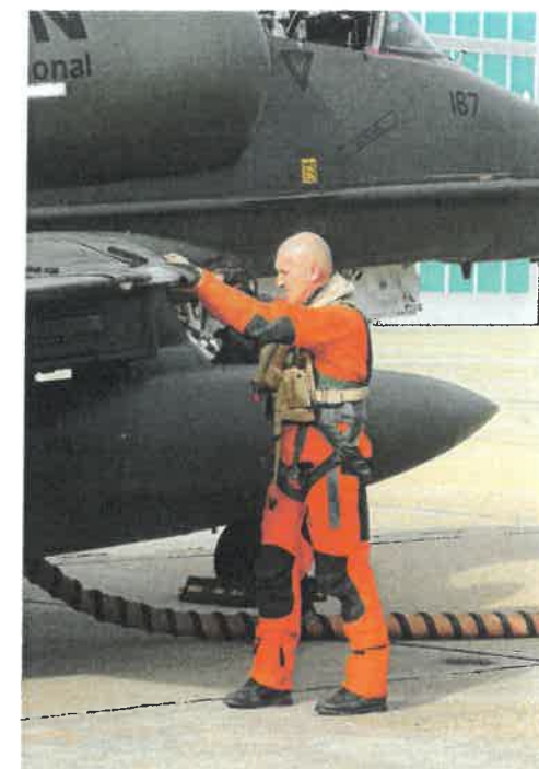
← Emmanuel Delin effectue la visite prévol de son A-4N avant un départ en mission. Ici, il vérifie le bon fonctionnement du bec de bord d'attaque gauche en poussant tout simplement dessus.
